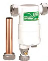
**Ultrakompaktní separátor pro topné systémy s magnetem** na odstraňování magnetických a nemagnetických nečistot. Mosazné tělo s bílou povrchovou úpravou. Rozebíratelný. 90° připojení. Měděná trubka průměr 18mm.
