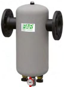
**Přírubový separátor nečistot pro domácí a průmyslové aplikace.** Odstraňuje magnetické i nemagnetické nečistoty, připojení od DN 50 až po DN 100, dodávaný s izolačním obalem.
