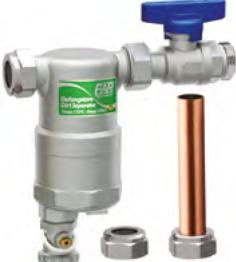
**Ultrakompaktní separátor pro topné systémy s magnetem** na odstraňování magnetických a nemagnetických nečistot. Mosazné tělo s chromovou povrchovou úpravou. Rozebíratelný. Přímé připojení. Měděná trubka průměr 18mm. Kulový ventil.
