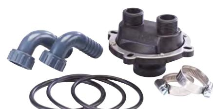
**Adaptér na tělo oběhového čerpadla.** Snadné připojení proplachovacího čerpadla na topení přes tělo oběhového čerpadla. Umožňuje čištění sekundárních výměníků tepla bez demontáže kotle. Kompatibilní se všemi běžně používanými oběhovými čerpadly.
