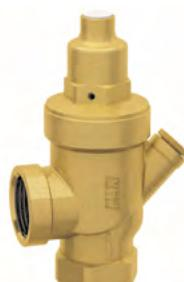
**Mosazný redukční ventil** pro zajištění konstantního tlaku pitné a užitkové vody v objektech od 1 do 6 bar. Zabraňuje tlakovým výkyvům z vodovodního řadu. Prodlužuje životnost vodovodních zařízení např. baterií, bojlerů, armatur a pod. Přednastavený na 5 bar. Možnost připojit manometr.
