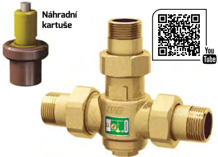
**Termostatický antikondenzační ventil proti kondenzaci.** Nezávisle reguluje teplotu vratné vody z nádrže teplé vody do palivového zdroje (kotle), zabraňuje kondenzaci na obvodě a dehtování. Dostupné provedení: 45 C, 55 C, 60 C, 70 C, 3/4 col, 1 col, 5/4 col.
