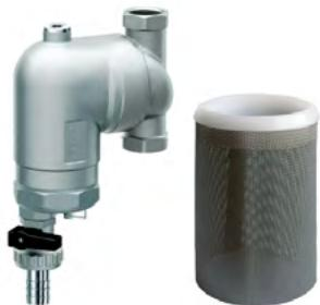
**Filtr na odstraňování magnetických a nemagnetických nečistot s otočným připojením o 360°.** Filtrace 300µm sítkem a magnetem. Mosazné tělo. Rozebíratelný.
