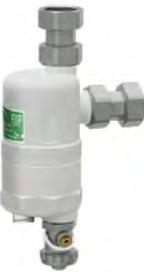
**Ultrakompaktní separátor pro vytápěcí systémy s magnetem** na odstraňování magnetických a nemagnetických nečistot. Mosazné tělo s bílou povrchovou úpravou. Rozebíratelný. 90° připojení.
