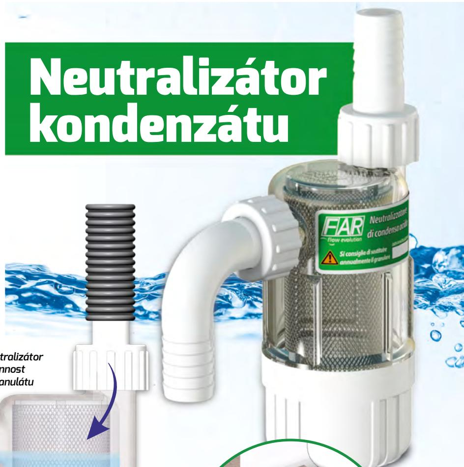
Pro zajištění správného provozu musí být neutralizátor nainstalovaný ve svíslé poloze. Konstantní účinnost granulátu lze zajistit pravidelnou výměnou granulátu v jednorocích intervalech.
