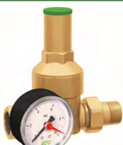
**Mosazný redukční ventil** pro zajištění konstantního tlaku pitné a užitkové vody v objektech od 1 do 6 bar. Zabraňuje tlakovým výkyvům z vodovodního řadu. Prodlužuje životnost vodovodních zařízení např. baterií, bojlerů, armatur a pod. Dodává se s regulačním klíčem.
