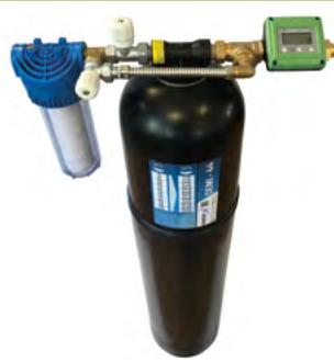
**Plnitelná mobilní jednotka na výrobu demineralizované vody.** Nepřetržitý proces úpravy vody včetně měřicího a monitorovacího zařízení el. vodivosti ( $\mu\text{S}/\text{cm}$  / TDS). Digitální měřič vody na výstupu jednotky (průtok, výstupní vodivost, sledování výstupu vodivosti). Vhodná pro doplňování uzavřených vytápěcích a chladicích okruhů. Včetně prvotní náplně a filtru na mechanické nečistoty 25  $\mu\text{m}$ .
