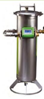
**Kompaktní přenosná jednotka na demineralizaci vody,** ideální pro prvotní plnění systémů, ale i na zabudování do systému, zařízení má integrovaný počítač pro kontrolu vyčerpání pryskyřice a sledování průtoku, na jedno naplnění umí upravit až 1200 l při 20 dH.
